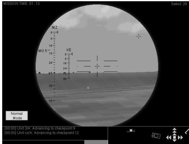
Abbildung 32: Das Turmzielfernrohr (TZF) des Richtschützen KPz Leopard2A4
